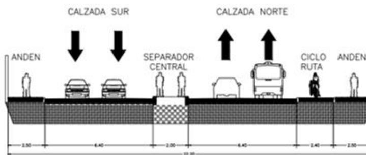
ILUSTRACIÓN 2: DISEÑO GEOMÉTRICO - SECCION TRANSVERSAL.
